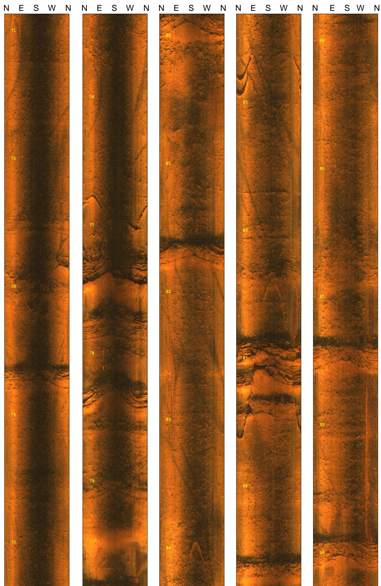
Figura 1c. Imagens OTV obtidas no poço W255, orientadas conforme o norte magnético.
