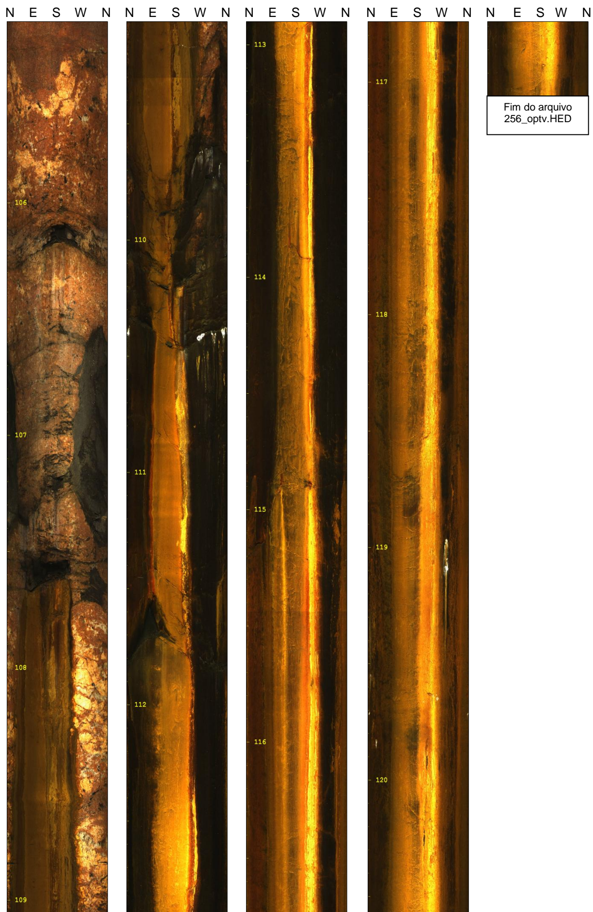
Figura 2c. Imagens OTV obtidas no poço W256, orientadas conforme o norte magnético.
