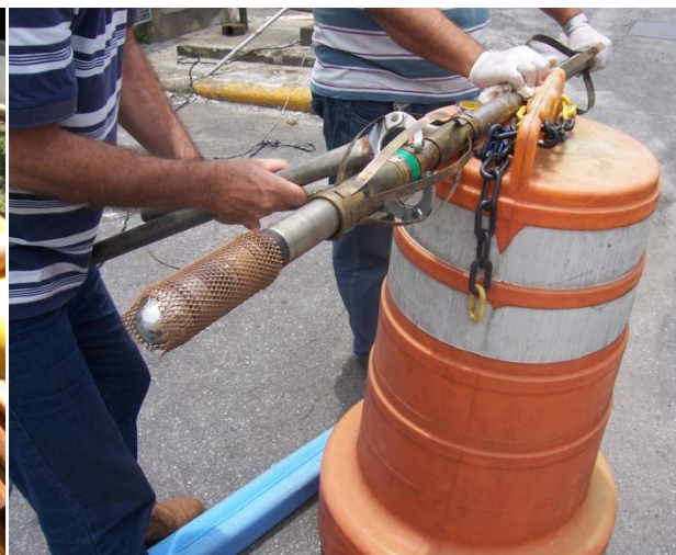
b) Perfilador ótico e centralizadores de sonda.
