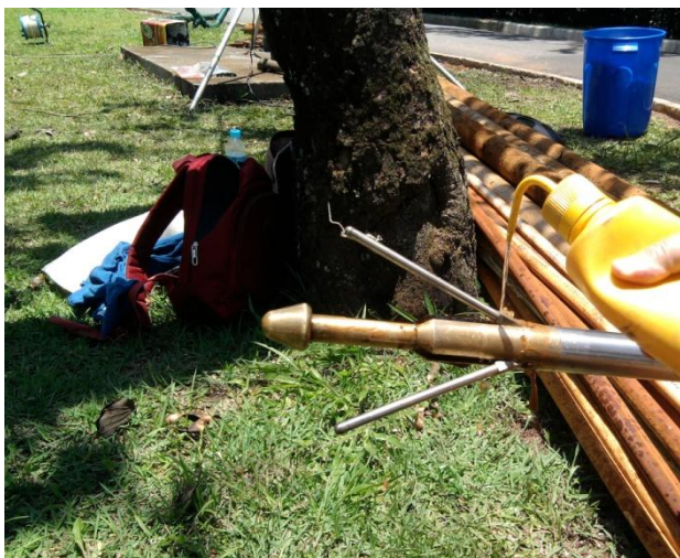
a) Hastes do perfilador de calibre acoplado ao perfilador de irradiação gama.
