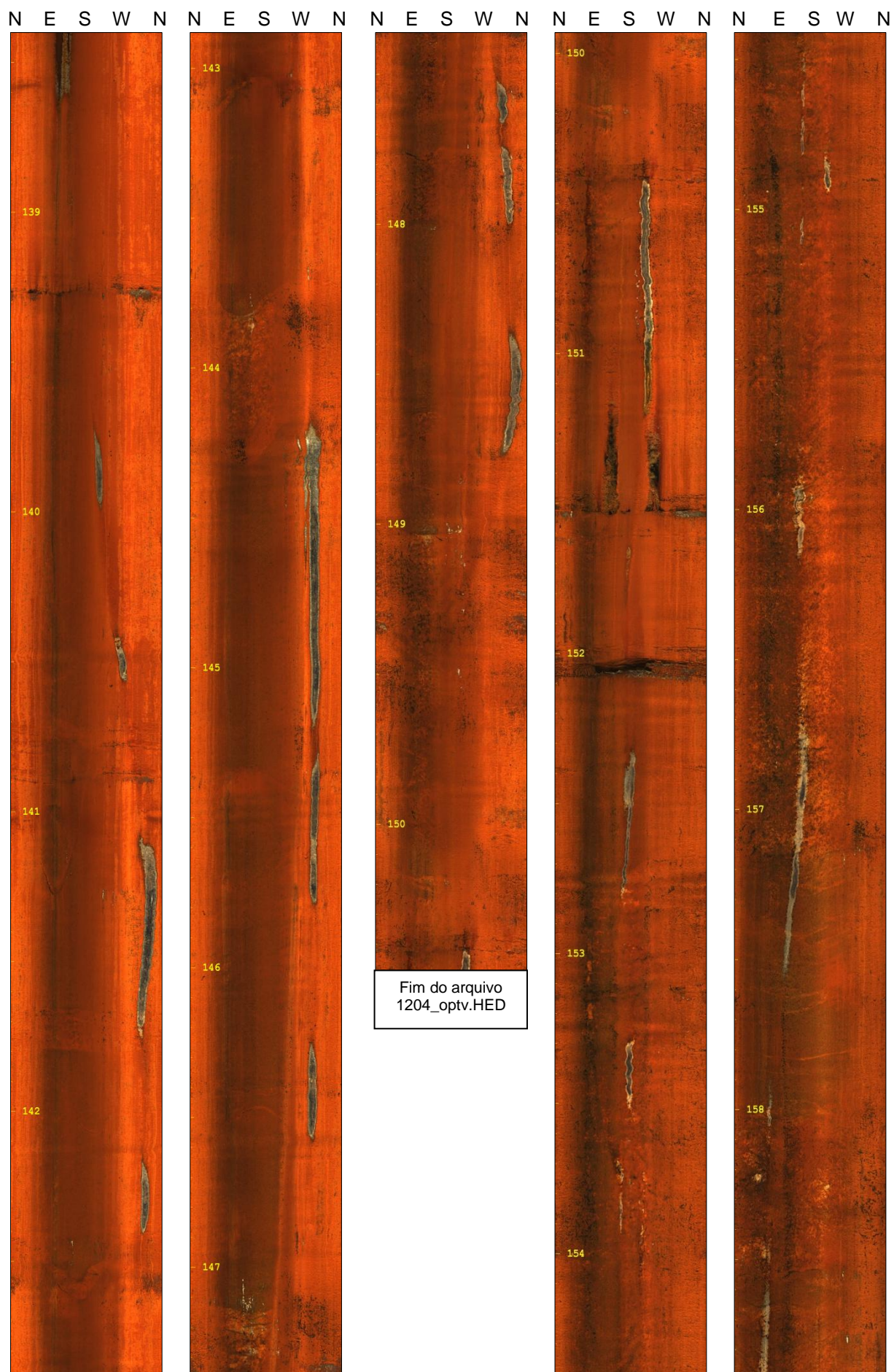
Figura 3e. Imagens OTV obtidas no poço W1204, orientadas conforme o norte magnético.
