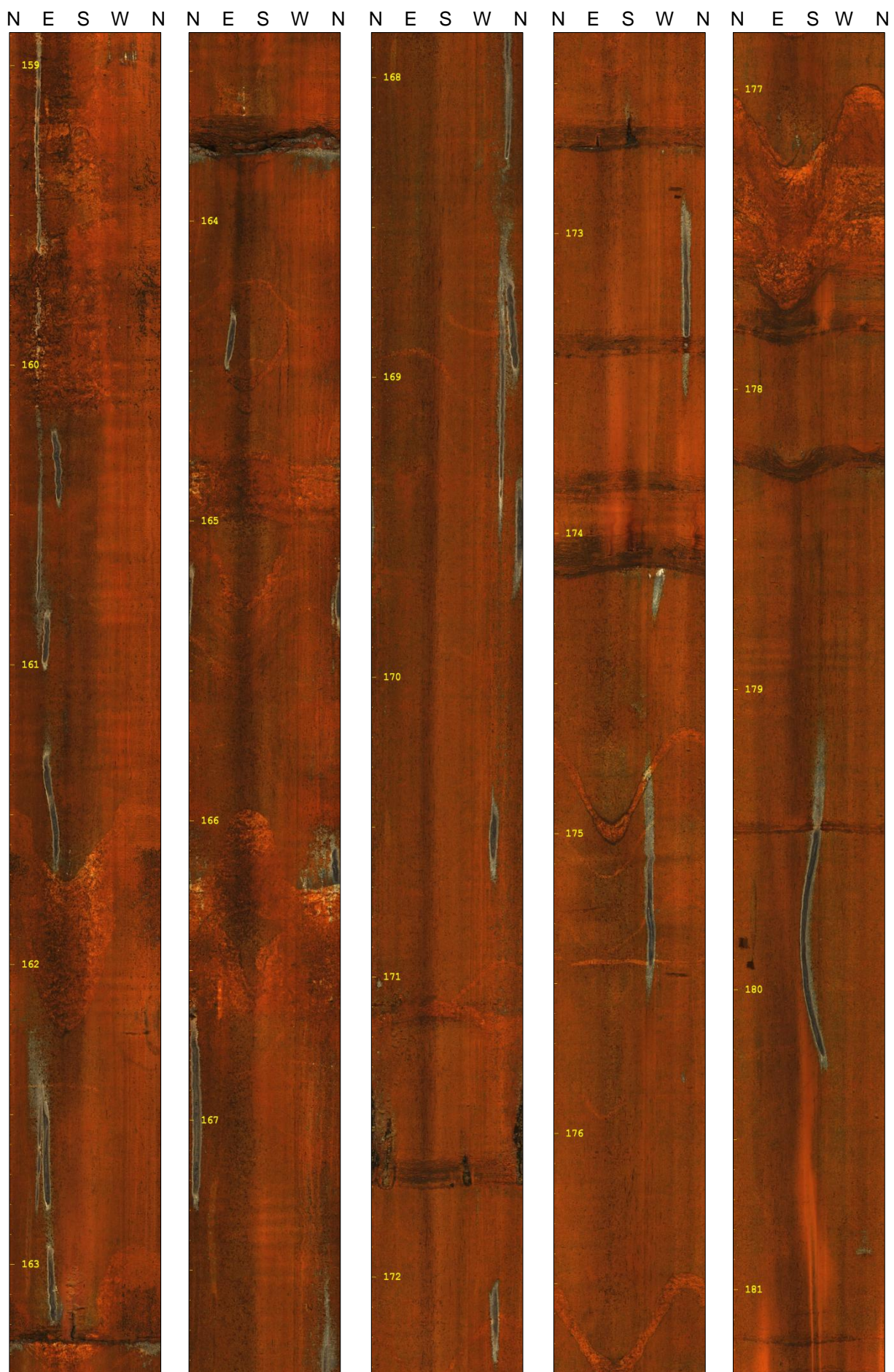
Figura 3f. Imagens OTV obtidas no poço W1204, orientadas conforme o norte magnético.
