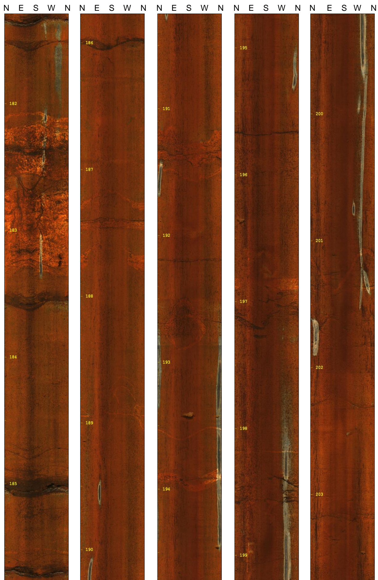
Figura 3g. Imagens OTV obtidas no poço W1204, orientadas conforme o norte magnético.
