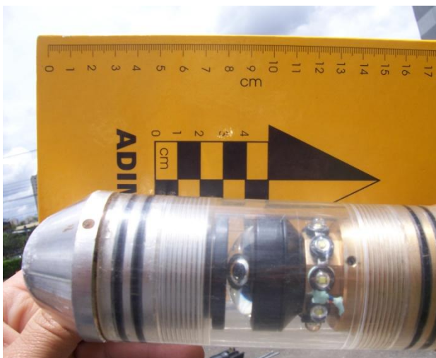
c) Câmera 360° do perfilador ótico e LEDs de iluminação.
