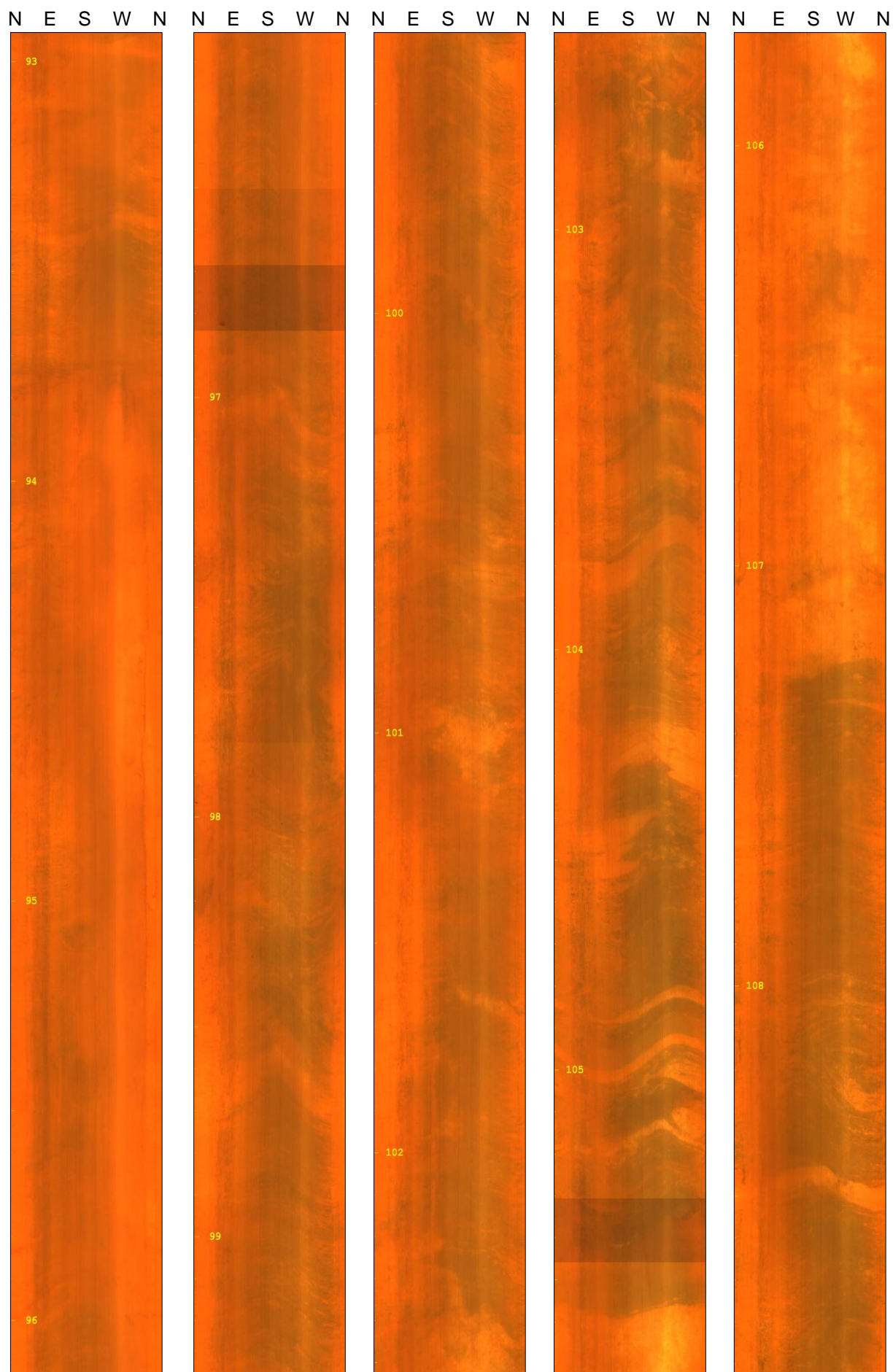
Figura 4c. Imagens OTV obtidas no poço W1346, orientadas conforme o norte magnético.
