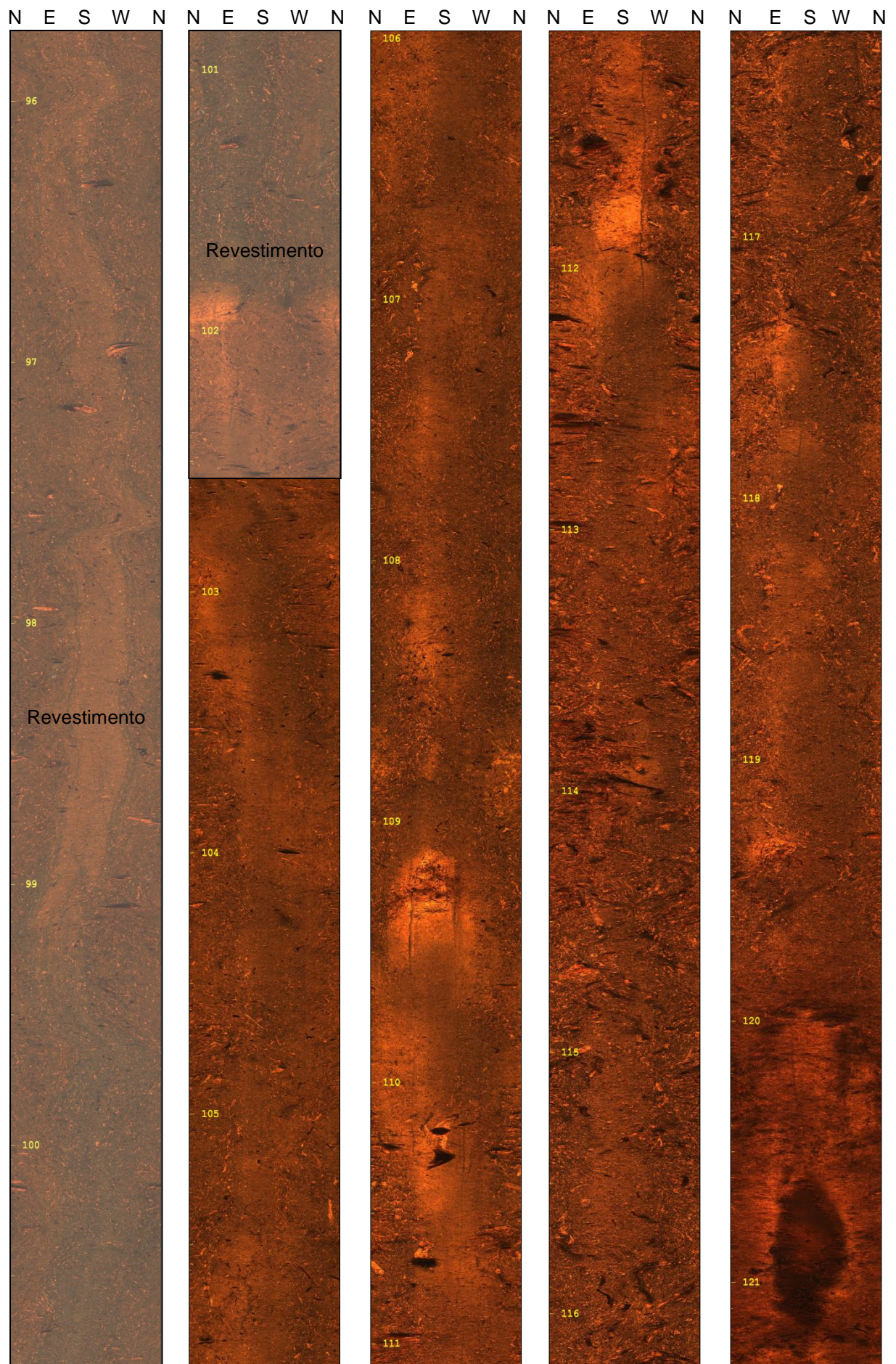
Figura 5c. Imagens OTV obtidas no poço W1401, orientadas conforme o norte magnético.
