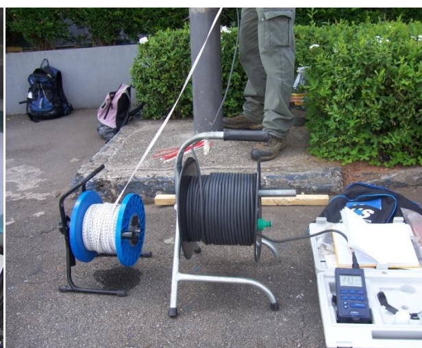
f) Cabo das sondas de condutividade elétrica e temperatura acoplada a um medidor de NA.
