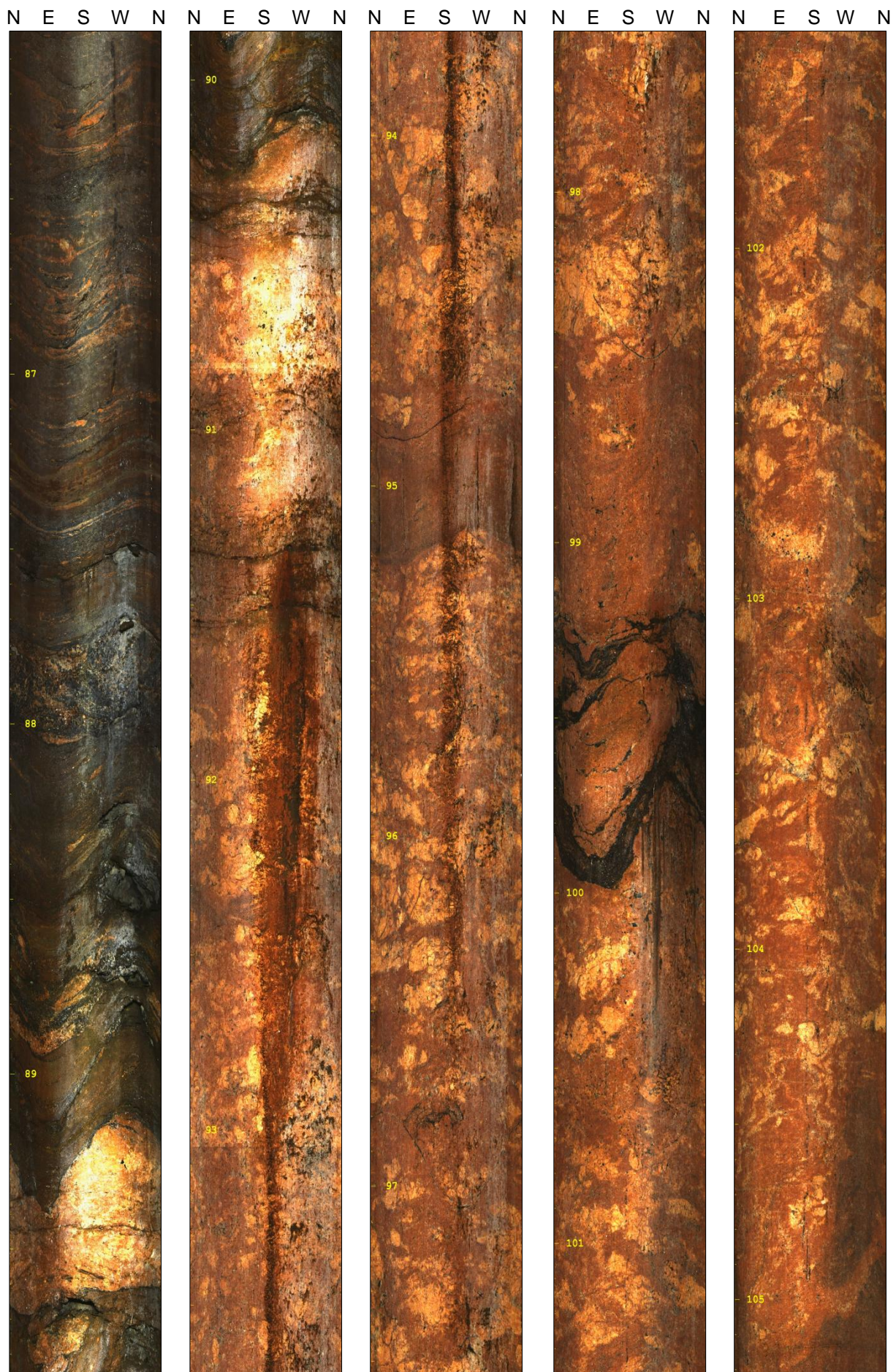
Figura 2b. Imagens OTV obtidas no poço W256, orientadas conforme o norte magnético.
