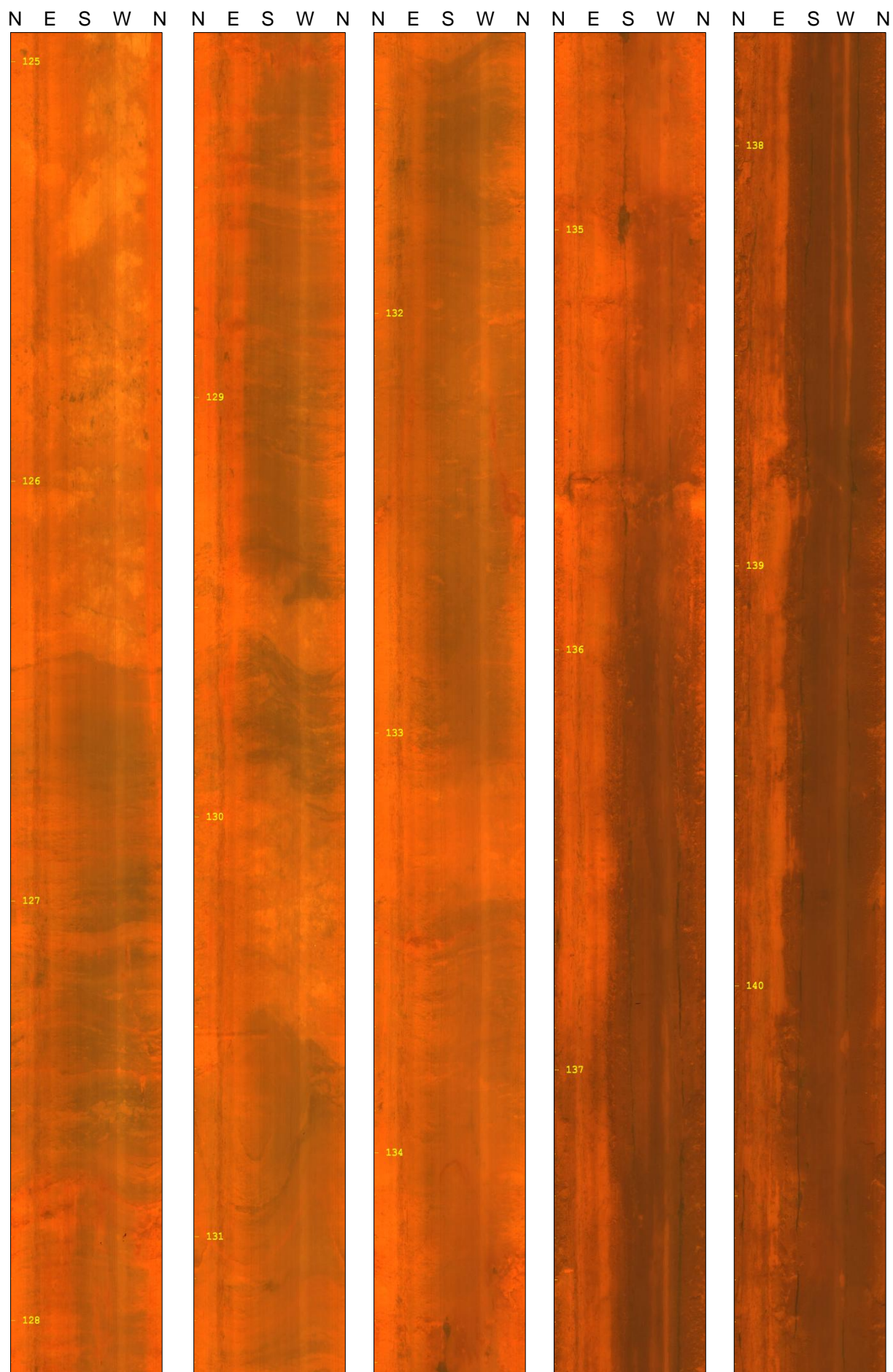
Figura 4e. Imagens OTV obtidas no poço W1346, orientadas conforme o norte magnético.
