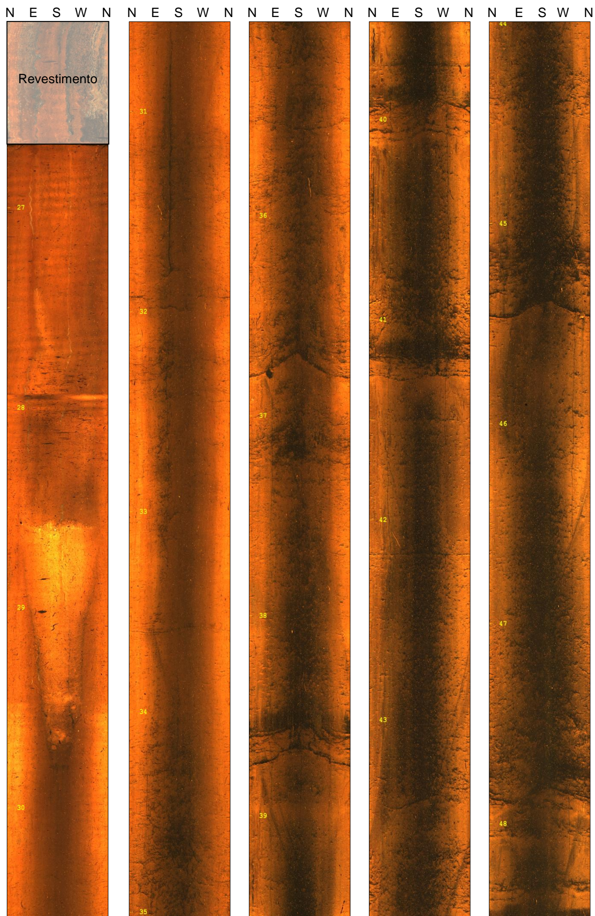
Figura 1a. Imagens OTV obtidas no poço W255, orientadas conforme o norte magnético.
